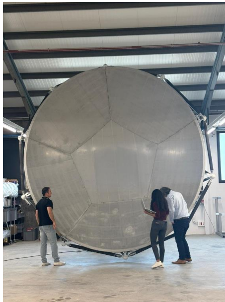
Inspection du sous-réflecteur du radiotélescope SKA-Mid sur le site de Compoxi.
