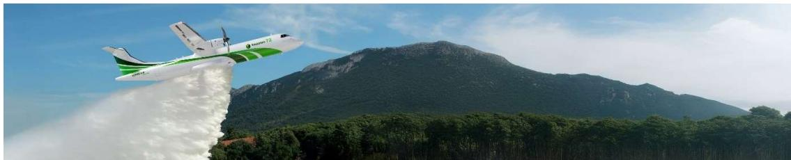
**Kepplair Evolution**, dont le siège social vient d'être implanté à Toulouse, développe un avion multi-rôle de lutte anti-incendie, **par conversion d'un ATR 72**. En utilisant une plateforme existante, le projet réduit **à trois ans** les délais de **mise sur le marché de nouveaux bombardiers d'eau et limite l'investissement initial**. Le bombardier d'eau **KEPPLAIR 72** est polyvalent, permettant également des missions de transport de fret et d'évacuation sanitaire.
